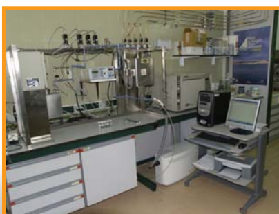
Instalación experimental para la determinación de las capacidades de retención de \text{SO}_2 y \text{NO}_x
