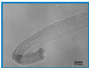
CNTs de pared simple obtenidos por arco
