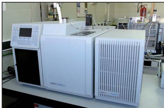
*Cromatógrafo Varian CP 3800 con detector Saturn 2200 MS-MS de trampa iónica*
