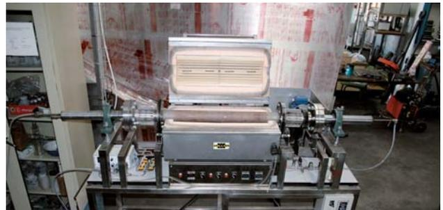
*Planta de lecho rotatorio para la descomposición catalítica de metano*
