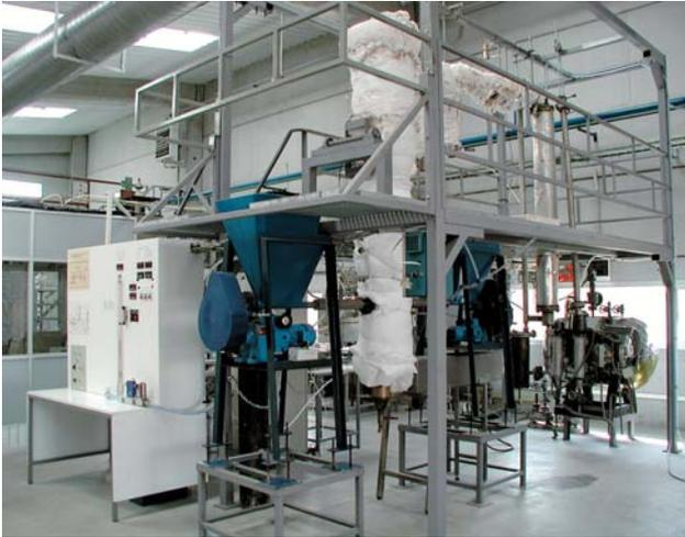
*Planta de gasificación de carbón, biomasa y residuos*
