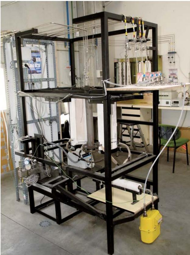
*Planta de lecho fluidizado para la descomposición catalítica de metano*
