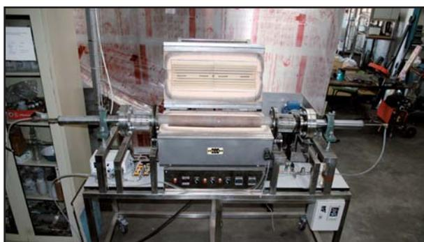
*Planta de lecho rotatorio para la descomposición catalítica de metano*
