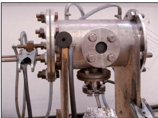
*Reactor de arco para la producción de Nanotubos de capa única y múltiple*
