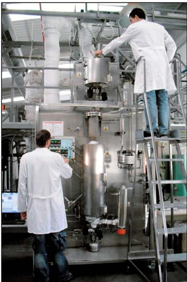
*Planta piloto para producción de hidrógeno por descomposición de metano*
