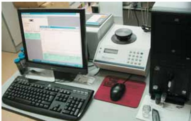
*Picnómetro de helio AccuPyc II 1340 de Micromeritics*
