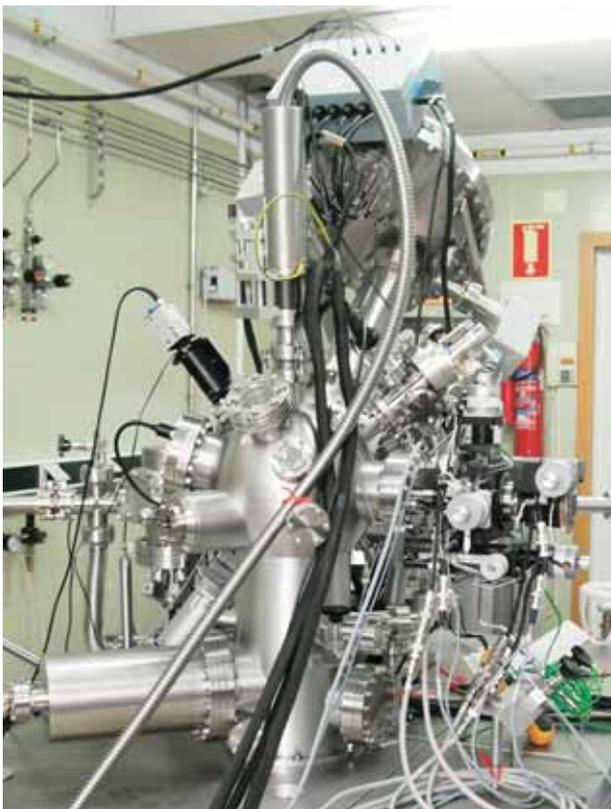
*Espectrómetro fotoelectrónico de rayos X Omicrom ESCA Plus*
